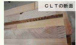
※CLT：木の板を繊維方向が直角になるように交互に重ねて接着したパネル
