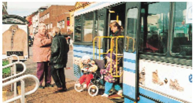
市バスの床高に合わせて、停留所の高床化がされている。バスには通常のステップがなく、代わりに収納式のブリッジとステップがあり、運転席からの操作で瞬時に出し入れができる。
