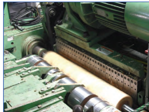
直径10cmの小径木も利用可能な合板加工施設(H22導入)
