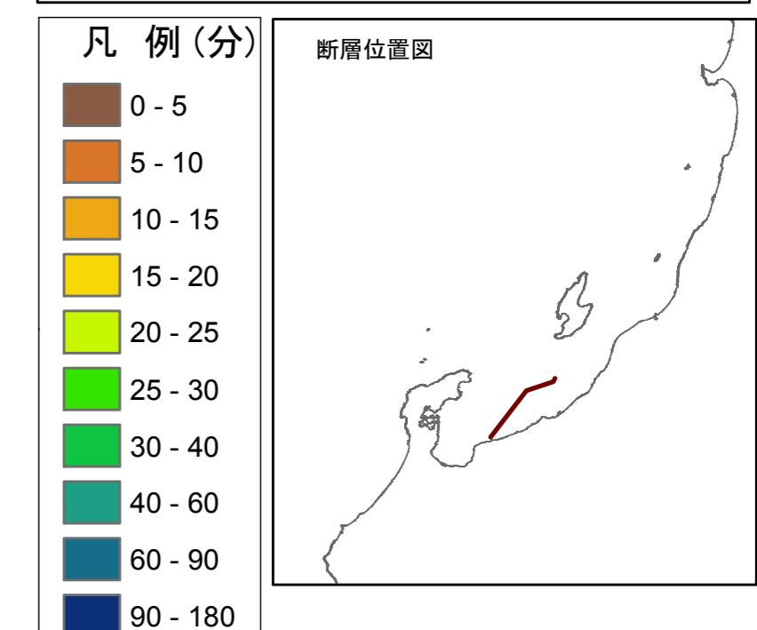
この津波浸水想定区域図は、能登半島東方沖を震源としたマグニチュード7.5の地震による津波の発生を想定し、陸域の浸水範囲などをシミュレーションした結果です。この区域図では、海岸線の護岸や河川堤防などの構造物がある場合を想定しています。
