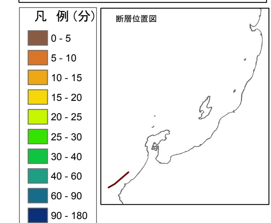
この津波浸水想定区域図は、石川県西方沖を震源としたマグニチュード7.44の地震による津波の発生を想定し、陸域の浸水範囲などをシミュレーションした結果です。この区域図では、海岸線の護岸や河川堤防などの構造物がある場合を想定しています。
