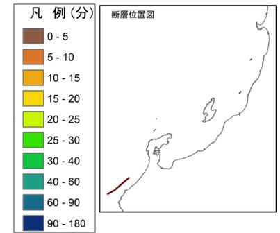
この津波浸水想定区域図は、石川県西方沖を震源としたマグニチュード7.44の地震による津波の発生を想定し、陸域の浸水範囲などをシミュレーションした結果です。この区域図では、海岸線の護岸や河川堤防などの構造物がない場合を想定しています。
