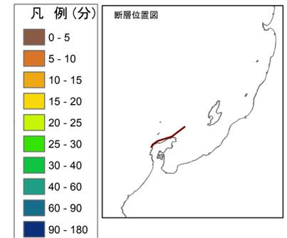
この津波浸水想定区域図は、能登半島北方沖を震源としたマグニチュード7.66の地震による津波の発生を想定し、陸域の浸水範囲などをシミュレーションした結果です。この区域図では、海岸線の護岸や河川堤防などの構造物がない場合を想定しています。
