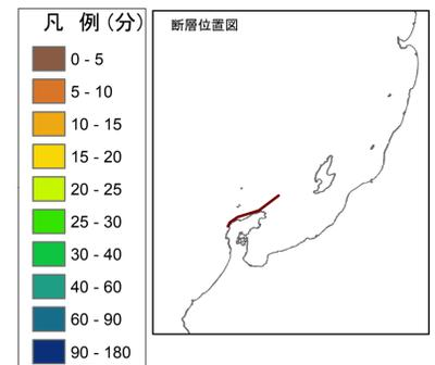
この津波浸水想定区域図は、能登半島北方沖を震源としたマグニチュード7.66の地震による津波の発生を想定し、陸域の浸水範囲などをシミュレーションした結果です。この区域図では、海岸線の護岸や河川堤防などの構造物がない場合を想定しています。
