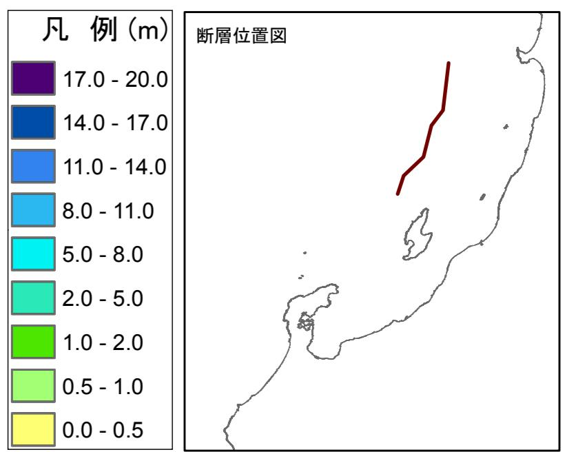
この津波浸水想定区域図は、日本海東縁部を震源としたマグニチュード7.99の地震による津波の発生を想定し、陸域の浸水範囲などをシミュレーションした結果です。この区域図では、海岸線の護岸や河川堤防などの構造物がある場合を想定しています。
