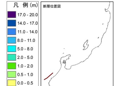
この津波浸水想定区域図は、石川県西方沖を震源としたマグニチュード7.44の地震による津波の発生を想定し、陸域の浸水範囲などをシミュレーションした結果です。この区域図では、海岸線の護岸や河川堤防などの構造物がある場合を想定しています。
