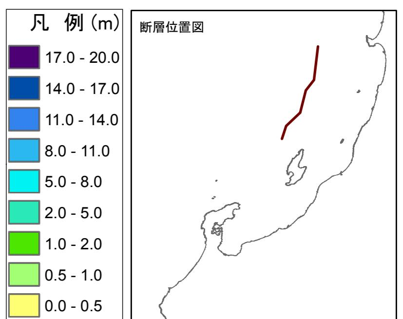
この津波浸水想定区域図は、日本海東縁部を震源としたマグニチュード7.99の地震による津波の発生を想定し、陸域の浸水範囲などをシミュレーションした結果です。この区域図では、海岸線の護岸や河川堤防などの構造物がない場合を想定しています。
