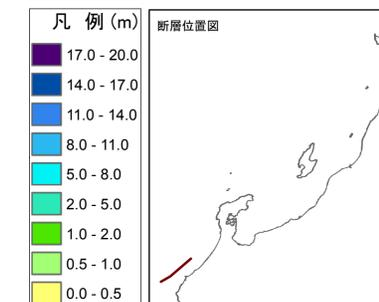
この津波浸水想定区域図は、石川県西方沖を震源としたマグニチュード7.44の地震による津波の発生を想定し、陸域の浸水範囲などをシミュレーションした結果です。この区域図では、海岸線の護岸や河川堤防などの構造物がない場合を想定しています。
