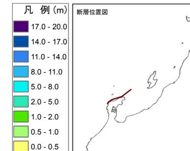
この津波浸水想定区域図は、能登半島北方沖を震源としたマグニチュード7.66の地震による津波の発生を想定し、陸域の浸水範囲などをシミュレーションした結果です。この区域図では、海岸線の護岸や河川堤防などの構造物がない場合を想定しています。
