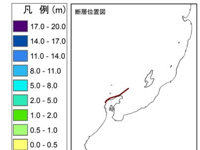
この津波浸水想定区域図は、能登半島北方沖を震源としたマグニチュード7.66の地震による津波の発生を想定し、陸域の浸水範囲などをシミュレーションした結果です。この区域図では、海岸線の護岸や河川堤防などの構造物がある場合を想定しています。
