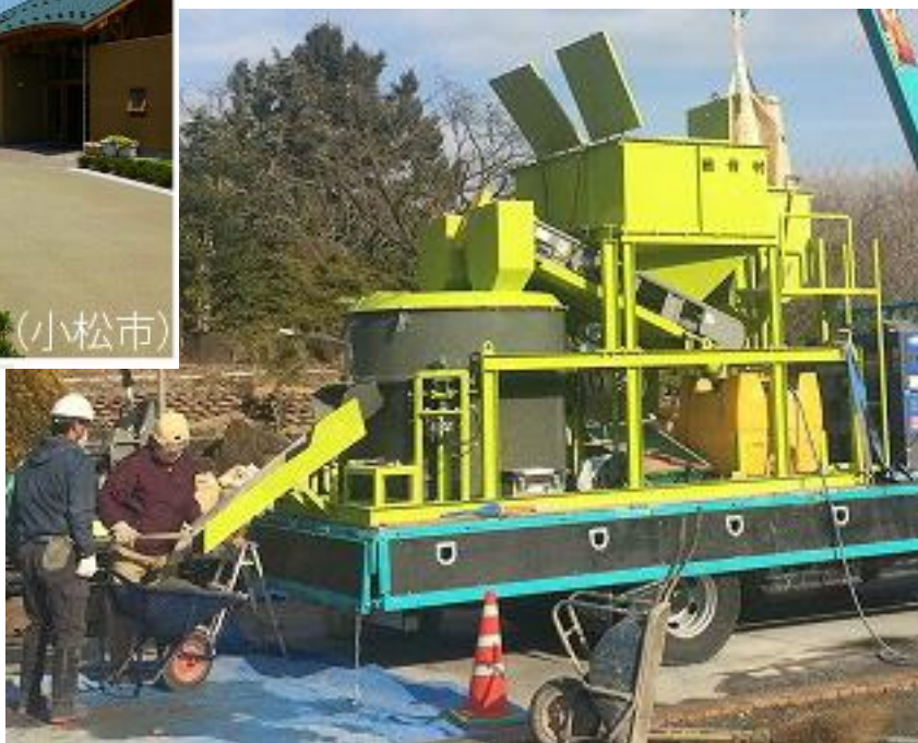
現場で特殊コンクリートを製造できる車載式プラント
