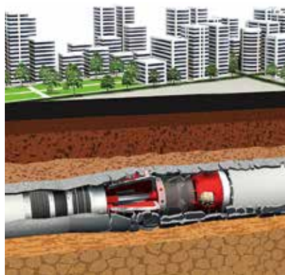
ベルリプレイス工法(改築推進工法)
