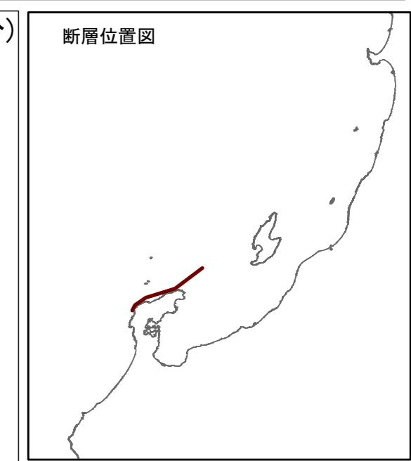
この津波浸水想定区域図は、能登半島北方沖を震源としたマグニチュード7.66の地震による津波の発生を想定し、陸域の浸水範囲などをシミュレーションした結果です。この区域図では、海岸線の護岸や河川堤防などの構造物がある場合を想定しています。
