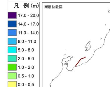
この津波浸水想定区域図は、能登半島東方沖を震源としたマグニチュード7.58の地震による津波の発生を想定し、陸域の浸水範囲などをシミュレーションした結果です。この区域図では、海岸線の護岸や河川堤防などの構造物がない場合を想定しています。
